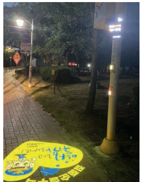
통합관제 센터와 연결, 고화질 다목적 CCTV, LED 안내판, 로고라이트를 설치한 통합방범장치 설치 [경기도 부천시]
