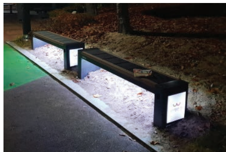
스마트폰 충전 야간 보안등 기능이 있는 태양광 스마트 IoT 벤치 [서울시 강동구]
