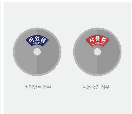
사용여부 설비는 색상과 문자로 표기하고 잠금장치와 연동되어 작동하도록 설치
